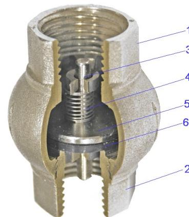
Клапан состоит из составного корпуса (поз. 1 и 2) из латуни CW 617N, в котором расположен подвижный золотник, состоящий из латунного штока (3), латунных золотниковых тарелок (5), между которыми помещена золотниковая прокладка из EPDM (6). Возврат золотника в седло обеспечивается пружиной (4) из нержавеющей стали AISI 304.
